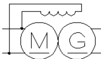
Przetwornica wirująca prądu stałego jednotwornikowa o wzbudzeniu elektromagnetycznym
