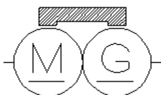
Przetwornica wirująca prądu stałego jednotwornikowa o wzbudzeniu elektromagnetycznym
