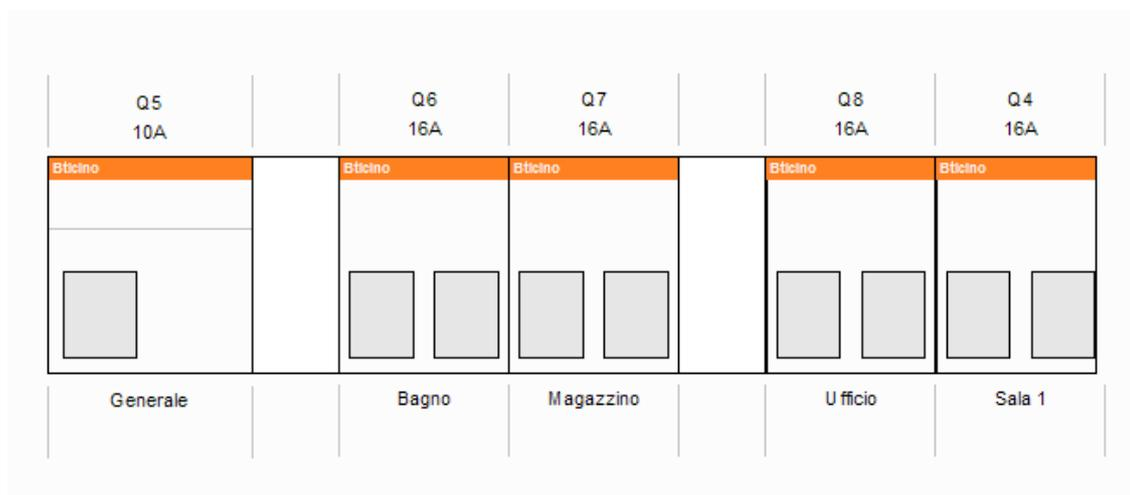
Per realizzare ciò dovete selezionare il materiale che andrà a trovarsi a dx dello spazio creato (nell'esempio superiore i componenti da selezionare sono stati Q6 e Q8) e dalla finestra **Proprietà** compilare il campo (riga) "Spaziatura" inserendo il valore desiderato.
