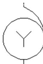
Autotransformator trójfazowy o uzwojeniach skojarzonych w gwiazdę
